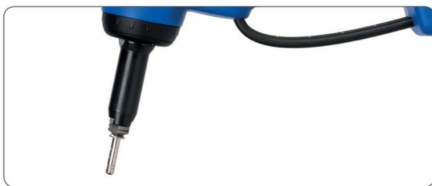
Das Festhaltemundstück hält den eingesteckten Niet durch Federkraft in jeder Position sicher fest. Somit kann das Setzgerät mit dem eingesteckten Niet in jeder Lage, auch nach unten, problemlos in das Bohrloch eingeführt werden ohne herauszufallen.
