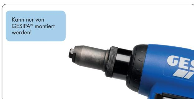
Durch die Andrückauslösung wird sichergestellt, dass die zu vernietenden Bauteile vor dem Nietvorgang zuverlässig ohne Spalt aufeinander liegen. Des Weiteren wird sichergestellt, dass der Blindniet seine Endlage in der Bohrung vor dem Setzvorgang erreicht und der Setzkopf anliegt. Die Andrückkraft kann je nach Anwendungsfall durch Federn variiert werden. Die Andrückauslösung ist auf Anfrage für alle Blindnietsetzgeräte der Bird-Serie nachrüstbar.
