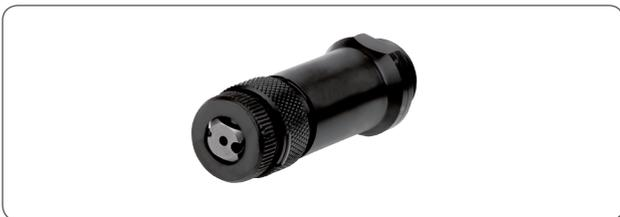
Das praktische Universal-Mundstück vereint bis zu fünf Mundstückgrößen. Der in die Stahlhülse integrierte Drehstern lässt sich ohne Werkzeug einfach und schnell entriegeln, um die gewünschte Mundstückgröße einzustellen. So setzt man verschiedene Nietabmessungen ohne Umrüstzeiten.
